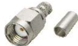
RSMA1111A3-NT50G-58U-50 Conector Macho, Crimp Tipo SMA (Pol. Invertida), 50 Ohm. Cable: RG-58/U
